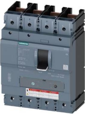
interruttore automatico 3VA5 UL Frame 400 classe del potere di interruzione C 100 kA con 480 V a 4 poli, protezione impianto TM240, ATAM, In=300 A protezione da sovraccarico Ir=240 A ... 300 A protezione da cortocircuito Ii=5 ... 10 x In protezione del conduttore di neutro 100 % senza collegamento
