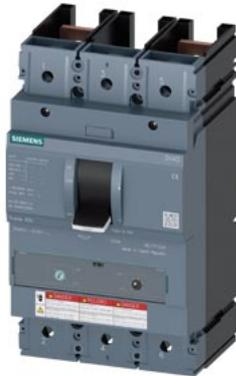
interruttore automatico 3VA5 UL Frame 400 classe del potere di interruzione H 65 kA con 480 V a 2 poli, protezione impianto TM230, FTAM, In=300 A protezione da sovraccarico Ir=300 A con regolazione fissa protezione da cortocircuito li=5 ... 10 x In senza collegamento
