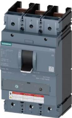
interruttore automatico 3VA5 UL Frame 400 classe del potere di interruzione C 100 kA con 480 V a 3 poli, protezione impianto TM240, ATAM, In=250 A protezione da sovraccarico Ir=200 A ... 250 A protezione da cortocircuito Ii=5 ... 10 x In senza collegamento
