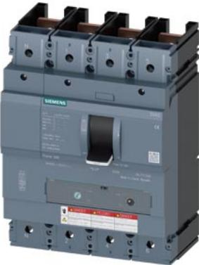
interruttore automatico 3VA5 UL Frame 400 classe del potere di interruzione M 35 kA con 480 V a 4 poli, protezione impianto TM230, FTAM, In=250 A protezione da sovraccarico Ir=250 A con regolazione fissa protezione da cortocircuito I<sub>c</sub>=5 ... 10 x In conduttore di neutro non protetto senza collegamento
