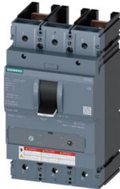
interruttore automatico 3VA5 UL Frame 400 classe del potere di interruzione C 100 kA con 480 V a 2 poli, protezione impianto TM230, FTAM, In=225 A protezione da sovraccarico Ir=225 A con regolazione fissa protezione da cortocircuito li=5 ... 10 x In senza collegamento
