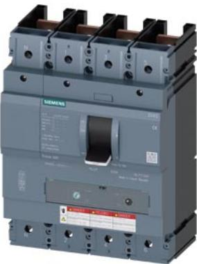
interruttore automatico 3VA5 UL Frame 400 classe del potere di interruzione C 100 kA con 480 V a 4 poli, protezione impianto TM240, ATAM, In=200 A protezione da sovraccarico Ir=160 A ... 200 A protezione da cortocircuito Ii=5 ... 10 x In conduttore di neutro non protetto senza collegamento
