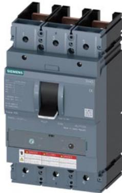
interruttore automatico 3VA5 UL Frame 400 classe del potere di interruzione C 100 kA con 480 V a 3 poli, protezione impianto TM230, FTAM, In=200 A protezione da sovraccarico Ir=200 A con regolazione fissa protezione da cortocircuito li=5 ... 10 x In senza collegamento
