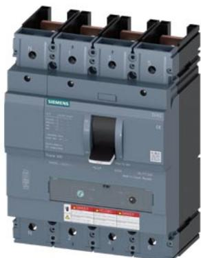
interruttore automatico 3VA5 UL Frame 400 classe del potere di interruzione H 65 kA con 480 V a 4 poli, protezione impianto TM240, ATAM,  $I_n=200$  A protezione da sovraccarico  $I_r=160$  A ... 200 A protezione da cortocircuito  $I_i=5$  ... 10 x  $I_n$  conduttore di neutro non protetto senza collegamento
