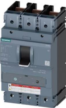
interruttore automatico 3VA5 UL Frame 400 classe del potere di interruzione H 65 kA con 480 V a 3 poli, protezione impianto TM230, FTAM, In=200 A protezione da sovraccarico Ir=200 A con regolazione fissa protezione da cortocircuito I<sub>c</sub>=5 ... 10 x In UL489 SB (Naval), 50 gradi Cel. senza collegamento
