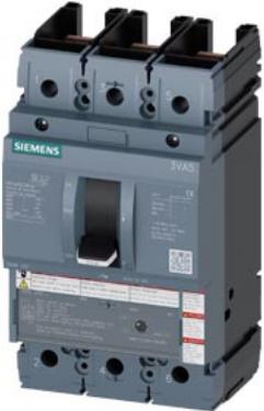
interruttore automatico 3VA5 UL frame 250 classe del potere di interruzione M 35 kA @ 480 V a 3 poli, protezione impianto TM210, FTFM, In=90 A protezione da sovraccarico Ir=90 A con regolazione fissa protezione da cortocircuito Ic=10 x In senza collegamento
