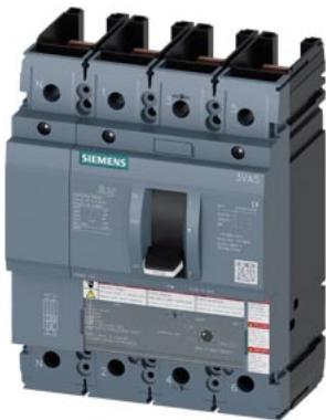
interruttore automatico 3VA5 UL frame 250 classe del potere di interruzione C 100 kA @ 480 V a 4 poli, protezione impianto TM230, FTAM, In=80 A protezione da sovraccarico Ir=80 A con regolazione fissa protezione da cortocircuito Ii=5 ... 10 x In conduttore di neutro non protetto senza collegamento
