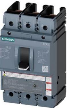
interruttore automatico 3VA5 UL frame 250 classe del potere di interruzione C 100 kA @ 480 V a 3 poli, protezione impianto TM230, FTAM, In=70 A protezione da sovraccarico Ir=70 A con regolazione fissa protezione da cortocircuito li=5 ... 10 x In senza collegamento
