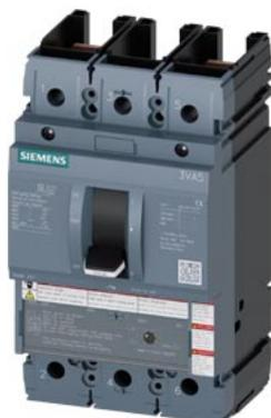
interruttore automatico 3VA5 UL frame 250 classe del potere di interruzione H 65 kA @ 480 V a 2 poli, protezione impianto TM210, FTFM, In=70 A protezione da sovraccarico Ir=70 A con regolazione fissa protezione da cortocircuito li=10 x In senza collegamento
