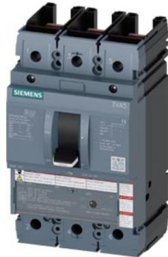
interruttore automatico 3VA5 UL frame 250 classe del potere di interruzione M 35 kA @ 480 V a 3 poli, protezione impianto TM210, FTFM, In=60 A protezione da sovraccarico Ir=60 A con regolazione fissa protezione da cortocircuito Ii=10 x In senza collegamento
