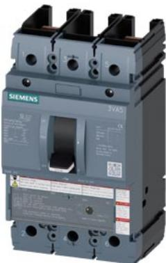
interruttore automatico 3VA5 UL frame 250 classe del potere di interruzione C 100 kA @ 480 V a 2 poli, protezione impianto TM210, FTFM, In=45 A protezione da sovraccarico Ir=40 A con regolazione fissa protezione da cortocircuito Ic=10 x In senza collegamento
