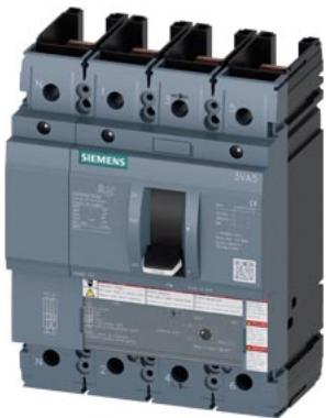
interruttore automatico 3VA5 UL frame 250 classe del potere di interruzione C 100 kA @ 480 V a 4 poli, protezione impianto TM210, FTFM, In=45 A protezione da sovraccarico Ir=40 A con regolazione fissa protezione da cortocircuito Ic=10 x In conduttore di neutro non protetto senza collegamento
