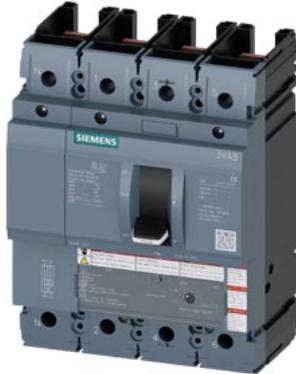
interruttore automatico 3VA5 UL frame 250 classe del potere di interruzione C 100 kA @ 480 V a 4 poli, protezione impianto TM210, FTFM, In=40 A protezione da sovraccarico Ir=40 A con regolazione fissa protezione da cortocircuito li=10 x In conduttore di neutro non protetto senza collegamento
