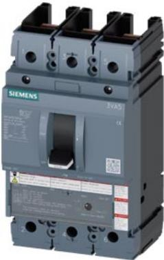
interruttore automatico 3VA5 UL frame 250 classe del potere di interruzione M 35 kA @ 480 V a 3 poli, protezione impianto TM210, FTFM, In=40 A protezione da sovraccarico Ir=40 A con regolazione fissa protezione da cortocircuito Ii=10 x In UL489 SB (navale), 50 gradi Cel. senza collegamento
