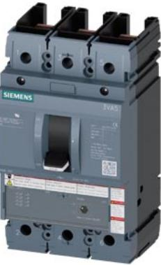
interruttore automatico 3VA5 UL frame 250 a 3 poli, protezione avviatore TM120M, AM, In=250 A senza protezione da sovraccarico protezione da cortocircuito li=3 ... 6 x In senza collegamento
