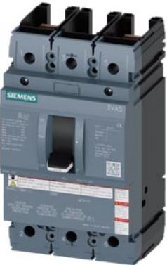
Interruttore scatolato 3VA5 UL Frame 250 potere di interruzione in cortocircuito max. 100kA @ 480 V a 2 poli, protezione impianto MCS110, In=250A senza protezione da sovraccarico protezione intrinseca li=10 x In senza collegamento
