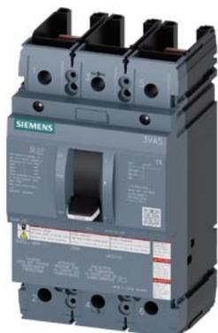
Interruttore scatolato 3VA5 UL Frame 250 potere di interruzione in cortocircuito max. 65kA @ 480V a 2 poli, protezione impianto MCS110, In=250A senza protezione da sovraccarico protezione intrinseca Ii=10 x In senza collegamento
