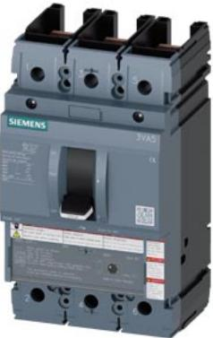
Interruttore automatico 3VA5 UL Frame 250 Classe del potere di interruzione H 65kA @ 480V a 3 poli, protezione impianto TM230, FTAM, In=225A protezione da sovraccarico Ir=225A impostazione fissa protezione da cortocircuito li=5 ... 10 x In UL 489 SB (Naval), 50° C senza collegamento
