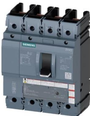
interruttore automatico 3VA5 UL frame 250 classe del potere di interruzione H 65 kA @ 480 V a 4 poli, protezione impianto TM210, FTFM, In=175 A protezione da sovraccarico Ir=175 A con regolazione fissa protezione da cortocircuito Ic=10 x In conduttore di neutro non protetto senza collegamento
