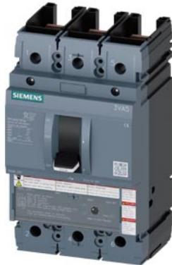
Interruttore automatico 3VA5 UL Frame 250 Classe del potere di interruzione H 65kA @ 480V a 3 poli, protezione impianto TM230, FTAM, In=175A protezione da sovraccarico Ir=175A impostazione fissa protezione da cortocircuito li=5 ... 10 x In UL 489 SB (Naval), 50° C senza collegamento
