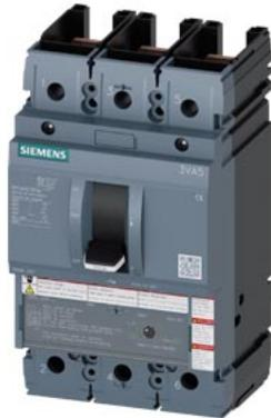
Interruttore automatico 3VA5 UL Frame 250 Classe del potere di interruzione H 65kA @ 480V a 3 poli, protezione impianto TM210, FTFM, In=150A protezione da sovraccarico Ir=150A impostazione fissa protezione da cortocircuito li=10 x In UL 489 SB (Naval), 50° C senza collegamento
