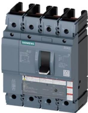
interruttore automatico 3VA5 UL frame 250 classe del potere di interruzione M 35 kA @ 480 V a 4 poli, protezione impianto TM240, ATAM, In=150 A protezione da sovraccarico Ir=120 A ... 150 A protezione da cortocircuito Ii=5 ... 10 x In protezione del conduttore di neutro 100 % senza collegamento
