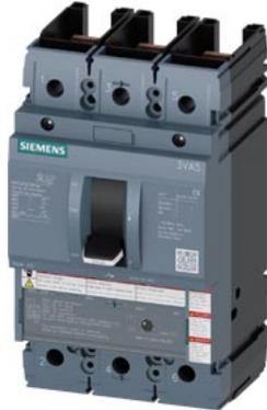
Interruttore automatico 3VA5 UL Frame 250 Classe del potere di interruzione M 35kA @ 480V a 3 poli, protezione impianto TM210, FTFM, In=150A protezione da sovraccarico Ir=150A impostazione fissa protezione da cortocircuito li=10 x In senza collegamento
