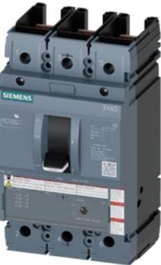
Interruttore automatico 3VA5 UL Frame 250 a 3 poli, protezione avviatore TM120M, AM,  $In=150A$  senza protezione da sovraccarico protezione da cortocircuito  $li=3...6 \times In$  senza collegamento
