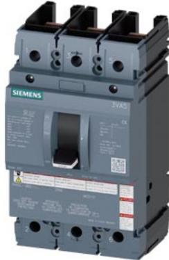
Interruttore scatolato 3VA5 UL Frame 250 potere di interruzione in cortocircuito max. 65kA @ 480V a 3 poli, protezione impianto MCS110, In=150A senza protezione da sovraccarico protezione intrinseca Ii=16 x In senza collegamento
