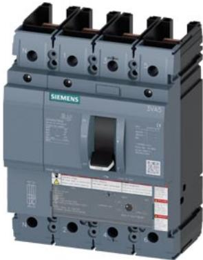
interruttore automatico 3VA5 UL frame 250 classe del potere di interruzione M 35 kA @ 480 V a 4 poli, protezione impianto TM240, ATAM, In=125 A protezione da sovraccarico Ir=100 A ... 125 A protezione da cortocircuito Ii=5 ... 10 x In protezione del conduttore di neutro 100 % senza collegamento
