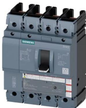
interruttore automatico 3VA5 UL frame 250 classe del potere di interruzione C 100 kA @ 480 V a 4 poli, protezione impianto TM230, FTAM, In=100 A protezione da sovraccarico Ir=100 A con regolazione fissa protezione da cortocircuito li=5 ... 10 x In protezione del conduttore di neutro 100 % senza collegamento
