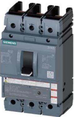
Interruttore automatico 3VA5 UL Frame 250 Classe del potere di interruzione C 100kA @ 480 V a 3 poli, protezione impianto TM210, FTFM, In=100A protezione da sovraccarico Ir=100 A con regolazione fissa protezione da cortocircuito Ic=10 x In senza collegamento
