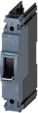
Interruttore automatico 3VA5 UL Frame 125 Classe del potere di interruzione M 35 kA con 277 V a 1 polo, protezione impianto TM210, FTFM, In=15A protezione da sovraccarico Ir=15 A con regolazione fissa protezione da cortocircuito Ii=20 x In senza collegamento
