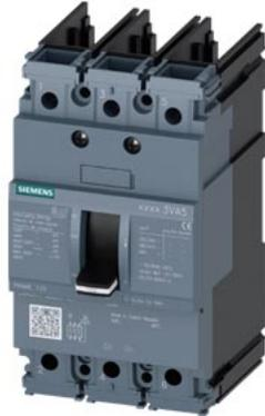
Interruttore automatico 3VA5 UL Frame 125 Classe del potere di interruzione S 25 kA con 480 V a 3 poli, protezione impianto TM210, FTFM, In=15A protezione da sovraccarico Ir=15 A con regolazione fissa protezione da cortocircuito Ii=20 x In senza collegamento
