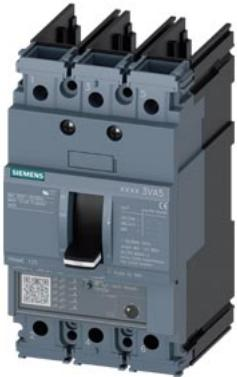
interruttore automatico 3VA5 UL Frame 125 a 3 poli, protezione avviatore TM120M, AM, In=10 A senza protezione da sovraccarico protezione da cortocircuito  $li=3 \dots 7 \times In$  senza collegamento
