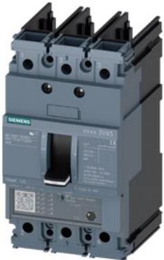
Interruttore automatico 3VA5 UL Frame 125 a 3 poli, protezione avviatore TM120M, AM,  $In=90A$  senza protezione da sovraccarico protezione da cortocircuito  $li=3 \dots 7 \times In$  senza collegamento
