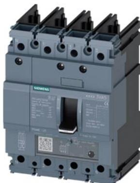
interruttore automatico 3VA5 UL Frame 125 classe del potere di interruzione S 25 kA con 480 V a 4 poli, protezione impianto TM240, ATAM, In=80 A protezione da sovraccarico Ir=63 A ... 80 A protezione da cortocircuito li=5 ... 10 x In conduttore di neutro non protetto senza collegamento
