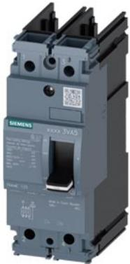
interruttore automatico 3VA5 UL Frame 125 classe del potere di interruzione H 65 kA con 480 V a 2 poli, protezione impianto TM210, FTFM, In=70 A protezione da sovraccarico Ir=70 A con regolazione fissa protezione da cortocircuito li=10 x In senza collegamento
