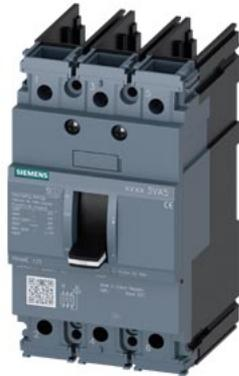
Interruttore automatico 3VA5 UL Frame 125 Classe del potere di interruzione S 25 kA con 480 V a 3 poli, protezione impianto TM210, FTFM, In=60A protezione da sovraccarico Ir=60 A con regolazione fissa protezione da cortocircuito Ii=10 x In UL 489 SB (Naval), 50° C senza collegamento
