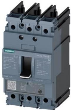
interruttore automatico 3VA5 UL Frame 125 classe del potere di interruzione H 65 kA con 480 V a 3 poli, protezione impianto TM240, ATAM, In=50 A protezione da sovraccarico Ir=40 A ... 50 A protezione da cortocircuito Ii=5 ... 10 x In senza collegamento
