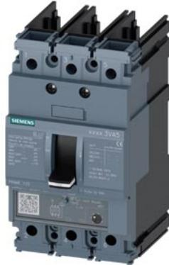
interruttore automatico 3VA5 UL Frame 125 classe del potere di interruzione M 35 kA con 480 V a 3 poli, protezione impianto TM240, ATAM, In=50 A protezione da sovraccarico Ir=40 A ... 50 A protezione da cortocircuito li=5 ... 10 x In senza collegamento
