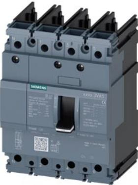
interruttore automatico 3VA5 UL Frame 125 classe del potere di interruzione S 25 kA con 480 V a 4 poli, protezione impianto TM210, FTFM, In=40 A protezione da sovraccarico Ir=40 A con regolazione fissa protezione da cortocircuito li=10 x In conduttore di neutro non protetto senza collegamento
