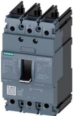
interruttore automatico 3VA5 UL frame 125 classe del potere di interruzione M 35 kA con 480V a 3 poli, protezione impianto TM210, FTFM, In=35 A protezione da sovraccarico Ir=35 A impostato fisso protezione da cortocircuito Ii=10 x In senza collegamento
