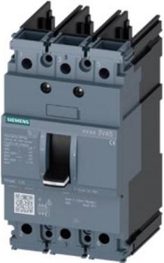
Interruttore automatico 3VA5 UL Frame 125 Classe del potere di interruzione S 25 kA con 480 V a 3 poli, protezione impianto TM210, FTFM, In=35A protezione da sovraccarico Ir=35 A con regolazione fissa protezione da cortocircuito Ii=10 x In UL 489 SB (Naval), 50° C senza collegamento
