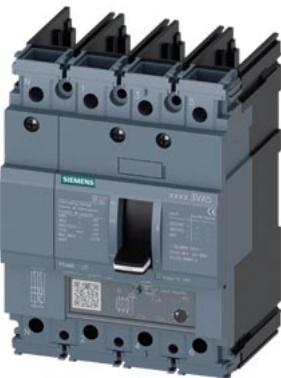
interruttore automatico 3VA5 UL Frame 125 classe del potere di interruzione M 35 kA con 480 V a 4 poli, protezione impianto TM240, ATAM, In=30 A protezione da sovraccarico Ir=24 A ... 30 A protezione da cortocircuito Ii=5 ... 10 x In conduttore di neutro non protetto senza collegamento
