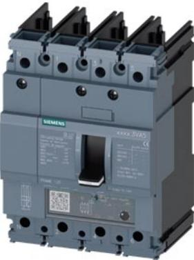
interruttore automatico 3VA5 UL Frame 125 classe del potere di interruzione S 25 kA con 480 V a 4 poli, protezione impianto TM240, ATAM, In=30 A protezione da sovraccarico Ir=24 A ... 30 A protezione da cortocircuito Ii=5 ... 10 x In conduttore di neutro non protetto senza collegamento
