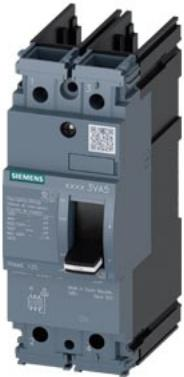
interruttore automatico 3VA5 UL Frame 125 classe del potere di interruzione M 35 kA con 480 V a 2 poli, protezione impianto TM210, FTFM, In=25 A protezione da sovraccarico Ir=25 A con regolazione fissa protezione da cortocircuito Ii=12 x In UL 489 SB (Naval), 50°C senza collegamento
