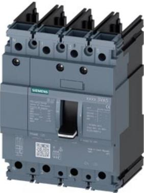
interruttore automatico 3VA5 UL Frame 125 classe del potere di interruzione S 25 kA con 480 V a 4 poli, protezione impianto TM210, FTFM, In=20 A protezione da sovraccarico Ir=20 A con regolazione fissa protezione da cortocircuito Ii=15 x In conduttore di neutro non protetto senza collegamento
