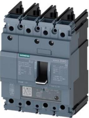
interruttore automatico 3VA5 UL Frame 125 classe del potere di interruzione H 65 kA con 480 V a 4 poli, protezione impianto TM230, FTAM, In=125 A protezione da sovraccarico Ir=125 A con regolazione fissa protezione da cortocircuito li=5 ... 10 x In conduttore di neutro non protetto senza collegamento
