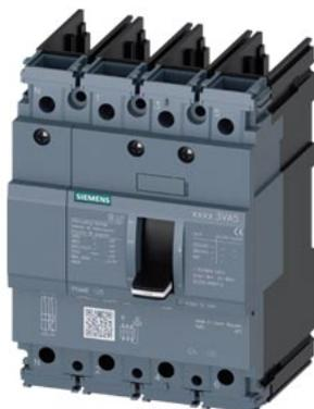
interruttore automatico 3VA5 UL Frame 125 classe del potere di interruzione M 35 kA con 480 V a 4 poli, protezione impianto TM210, FTFM,  $I_n=125$  A protezione da sovraccarico  $I_r=125$  A con regolazione fissa protezione da cortocircuito  $I_i=10 \times I_n$  conduttore di neutro non protetto senza collegamento
